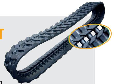
El **Sistema AVT** (Anti-Vibration Track) es una nueva tecnología que incorpora las cadenas de goma Trabber, y que consiste en que el rodillo inferior esté permanentemente apoyado en los dientes guía con forma de DIAMANTE. El resultado es una importante reducción de vibraciones.
